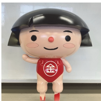
FDM方式3Dプリンターを使用し た立体造形の製作
