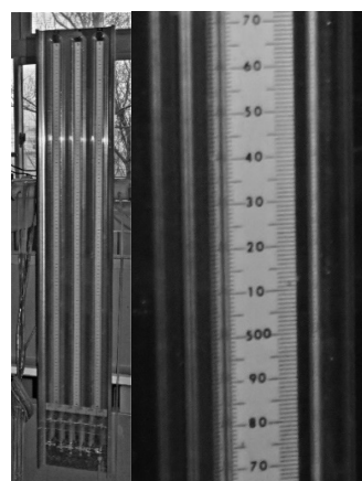
図2 U字管マンオメータ (左: 全景, 右: 目盛)
