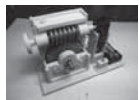
図3 ウォームギヤモデル
