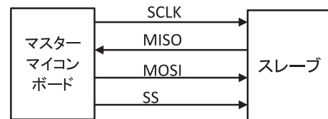
図2 SPIバスによる構成例
