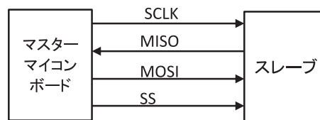
図2 SPIバスによる構成例
