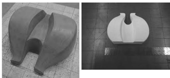
図1 使用したクレイモデルと出力した石膏モデル
