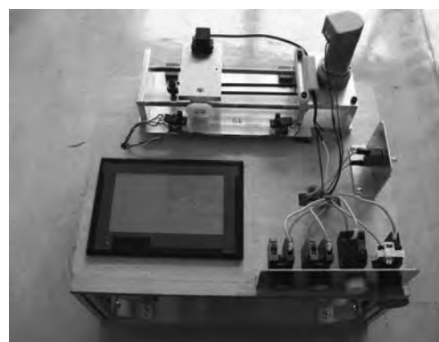
図2 Misumi製表示器を用いた一軸テーブル
