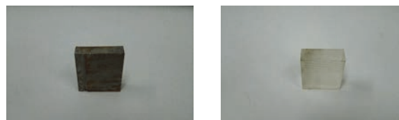
図3 試験片（左：鉄製、右：アクリル製）
