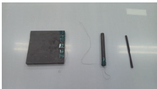
図2 電極（左 平板 右 円柱）
