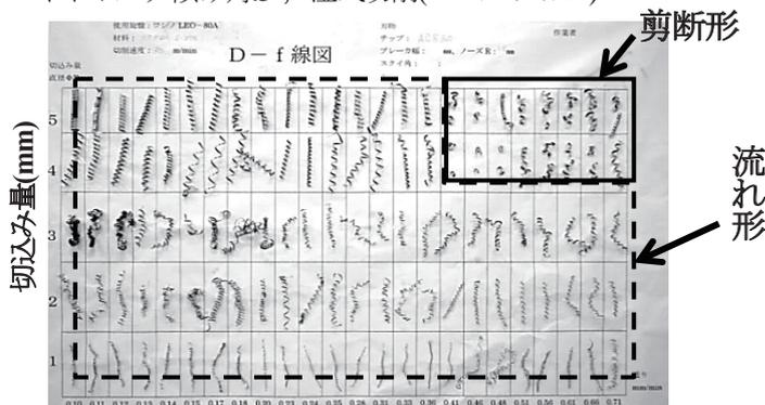
Fig.2 D-F線図 送り速度(mm/rev)
