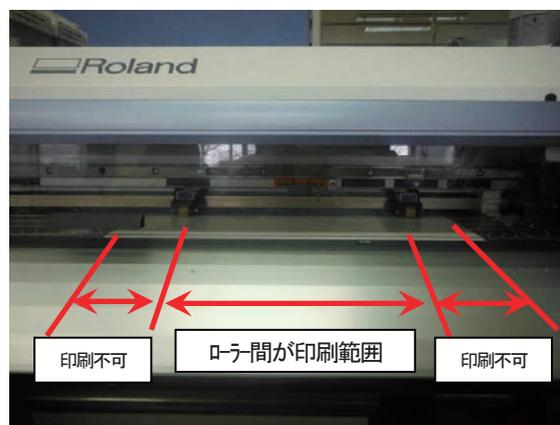
図 2 印刷サイズに対応したカッティングシート
