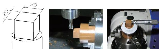
図 1 正四角柱の加工風景と測定箇所
