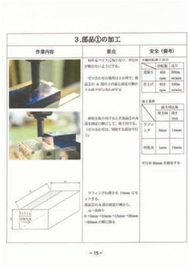
図2 技能検定フライス盤作業3級実技対策テキスト
